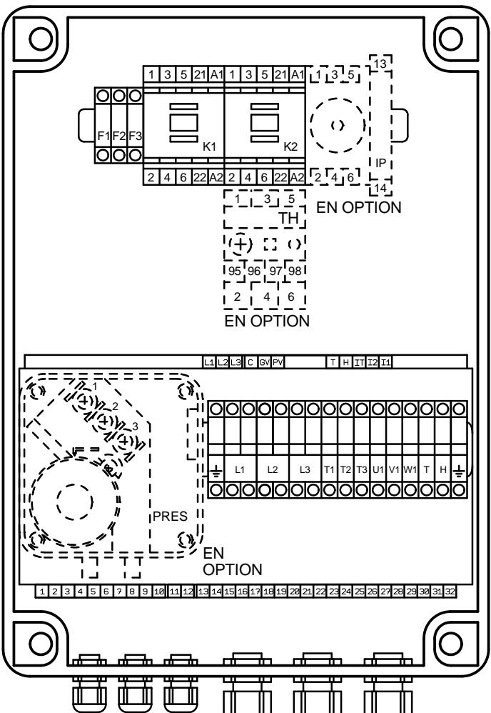
Presse-étoupes pour raccordement d'appareils déportés au coffret (CMSI, pressostat, contact auxiliaire de l'interrupteur de proximité, ...)
