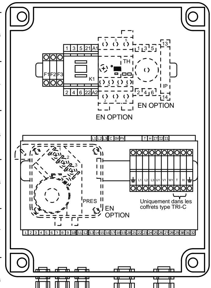
Presse-étapes pour raccordement d'appareils déportés au coffret (CMSI, pressostat, contact auxiliaire de l'interrupteur de proximité, ...)
