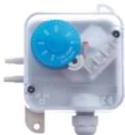
Il informe le coffret de relayage d'un débit d'air suffisant pour assurer la fonction de désenfumage. Le pressostat différentiel est équipé de contacts auxiliaires NO et NC sur 2 plages de pression : **30 à 500 Pa** et **100 à 1500 Pa** (pour les plages supérieures, nous consulter).
