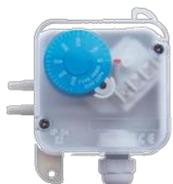
Il informe le coffret de relayage d'un débit d'air suffisant pour assurer le désenfumage. Il est équipé de contacts auxiliaires NO et NC sur 3 plages de pression : **30 à 500 Pa, 100 à 1500 Pa et 500 à 4500 Pa.**
